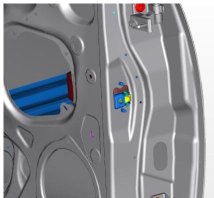
4.1.15、拔下左前门线束与室内线束连接的插头，
